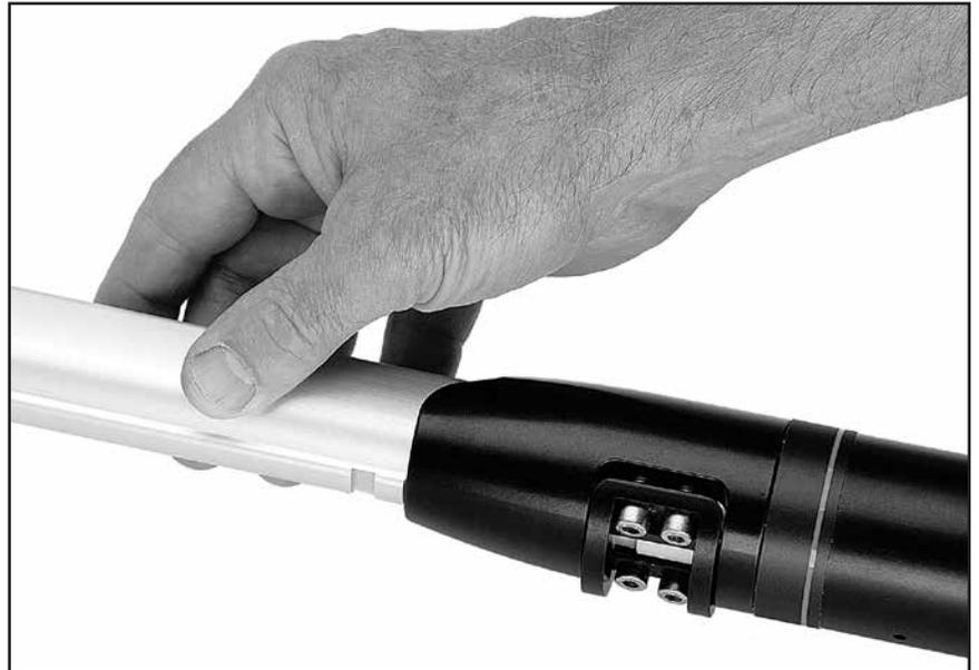
Glisser l'émerillon de drisse au-dessus du profil. Placer l'engoujure dans le renforcement du profil. Pousser la vis vers le bas de sorte que la cale se prenne sous le profil. Serrer la vis.
