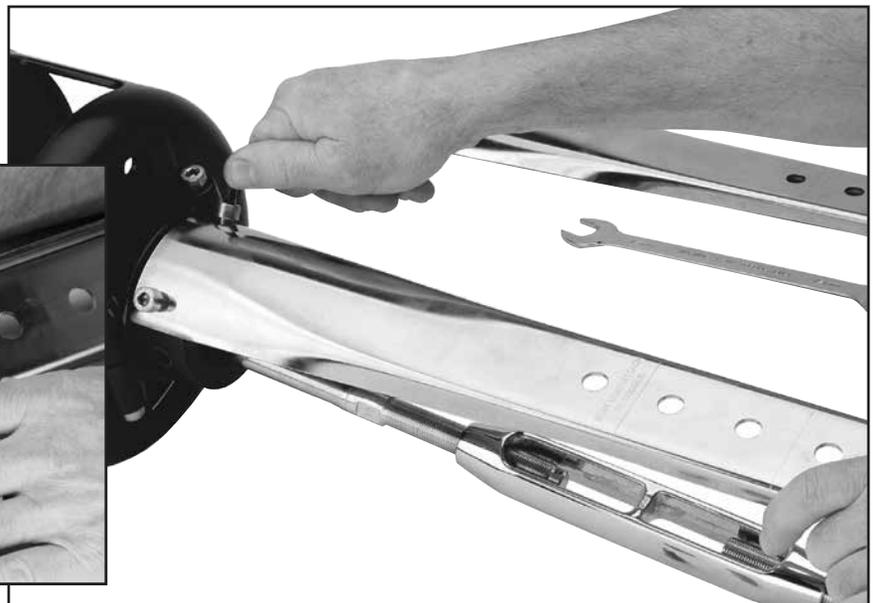
Attacher une deuxième latte ridoir longue au tambour et fixer à l'axe à épaulement à l'aide des contre-écrous.
