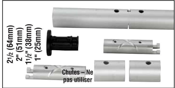
**2 1/2" - 1" (64 - 25mm)** Raccourcir le profil supérieur et le profil pleine longueur adjacent pour utiliser deux vis pour assembler le joint au lieu de quatre. Ne pas utiliser de douilles en plastique au-dessus du connecteur supérieur.
