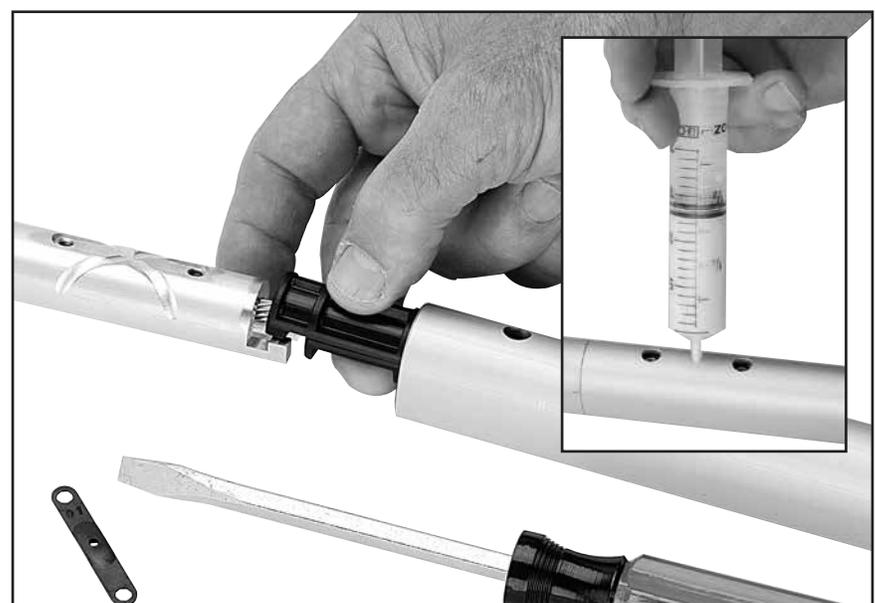
Poursuivre l'installation des connecteurs et des cales. Veiller à systématiquement appliquer une goutte de Loctite® rouge dans les trous de vis.
