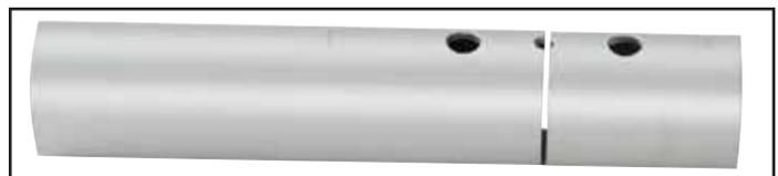
**\*Pour permettre le sciage, placer la lame de sorte à préserver la moitié supérieure du trou central.**
