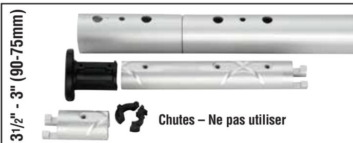
**3 1/2" - 3" (90 - 75mm)** Ne pas utiliser de douille en plastique au-dessus du connecteur supérieur. Couper le connecteur juste au niveau de la croix formée par le canaux de dispersion de colle. Utiliser la vis de profil dans le profil supérieur seulement.
