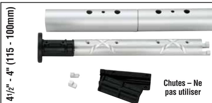
**4 1/2" - 4" (115 - 102mm)** Ne pas utiliser de douille en plastique au-dessus du connecteur supérieur. Raccourcir le haut du connecteur et, au besoin, raccourcir le bouchon obturateur.
