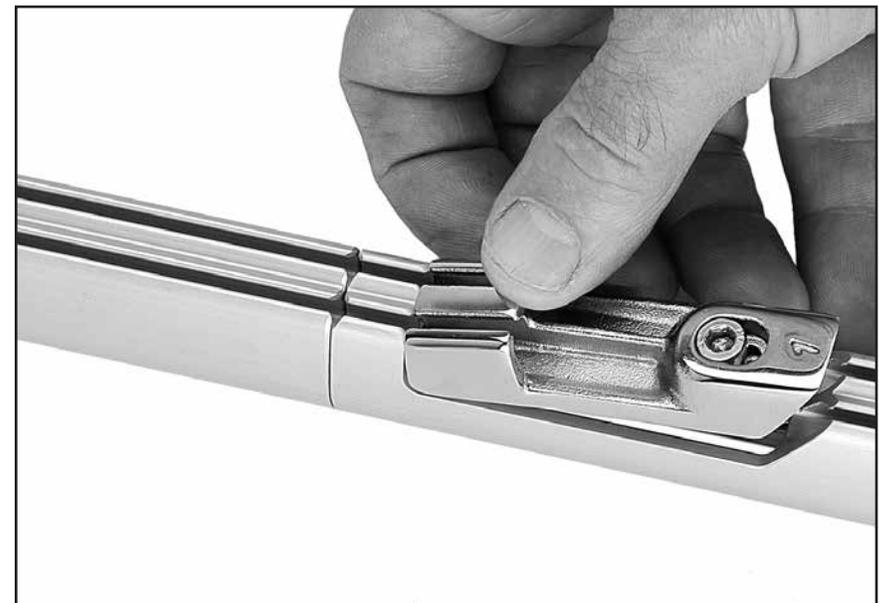
**N.B. :** La vis aura du mal à tourner. Elle est revêtue de plastique pour éviter son desserrage sous l'effet des vibrations.
