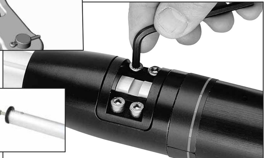
**Astuce :** Ne pas déposer les vis de la bride de serrage du profil pour ajuster le profil. Desserrer les vis, tenir les profils et éloigner la bride de serrage des profils. Ajuster et resserrer.
