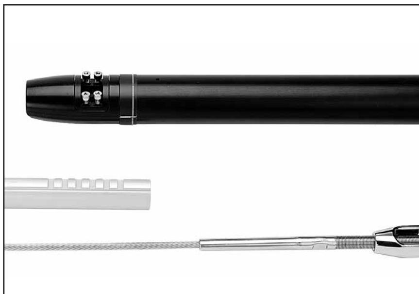
**N.B. :** Positionner le profil supérieur de sorte qu'avec le bouchon supérieur il se trouve à 1/2" (13 mm) en dessous de la terminaison. Si la terminaison du câble en haut de l'étai est sertie, le profil doit se positionner juste en dessous de l'épaulement du sertissage. Marquer la ligne de coupe sur le profil. Enrouler le profil d'un ruban qui vous servira de guide de coupe droite.
