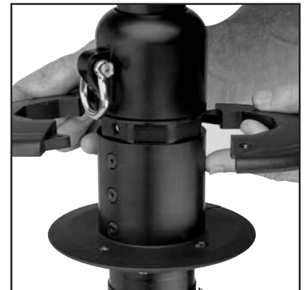
Einfädler vorsichtig abheben - unten zuerst. Nicht über Bord gehen lassen!
