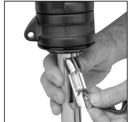
Einfädler vorsichtig abheben - unten zuerst. Nicht über Bord gehen lassen!
