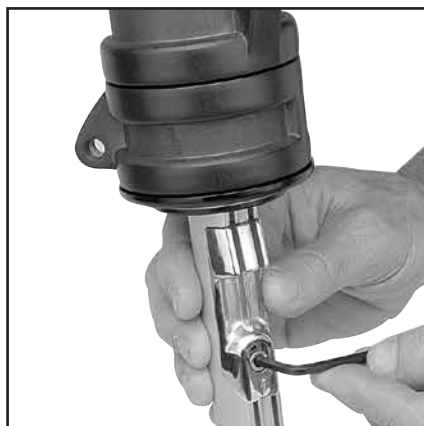
Schraube nur eine Umdrehung lösen .
