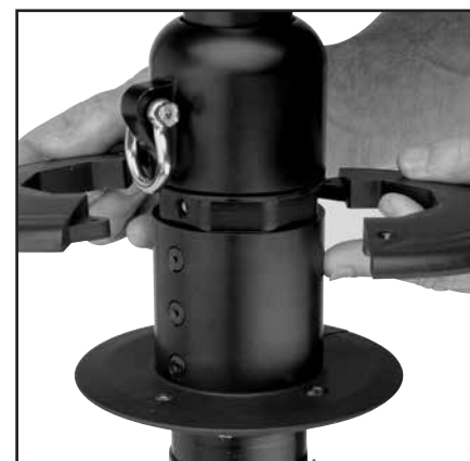
Einfädler vorsichtig abheben - unten zuerst. Nicht über Bord gehen lassen!
