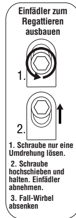
Schraube nur eine Umdrehung lösen .
