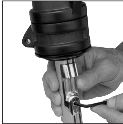
Schraube nur eine Umdrehung lösen .
