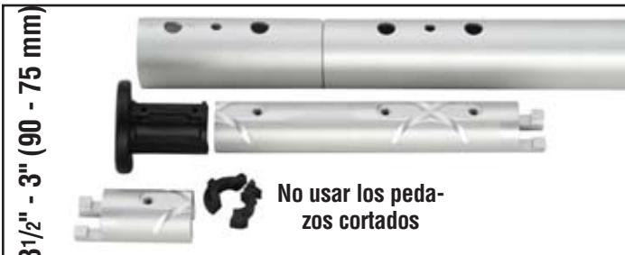
3 1/2" - 3" (90 - 75 mm) No use un buje de plástico por encima del conector superior. Corte el conector justo en el cruce formado por los canales de dispersión de pegamento. Utilice sólo un tornillo de perfil en el perfil superior.
