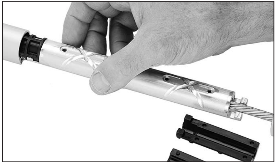
Carga del inyector con adhesivo
