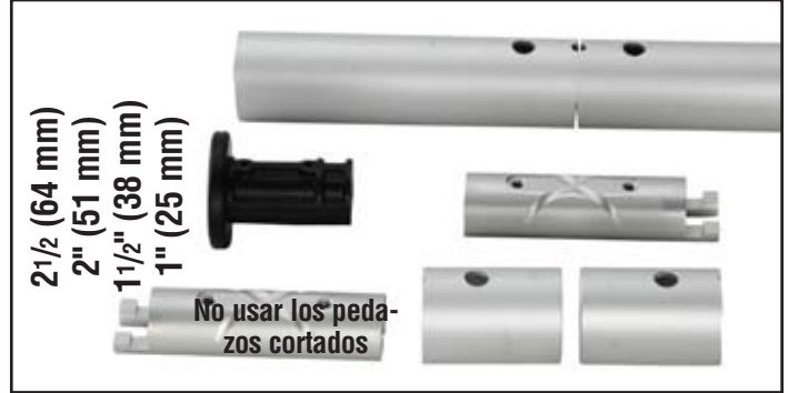
2 1/2" - 1" (64 - 25 mm) Acorte el perfil superior y el perfil contiguo de longitud total, de modo que se usen dos tornillos en vez de cuatro para ensamblar la unión. No utilice bujes de plástico por encima del conector superior.
