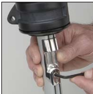
Afloje el tornillo solamente una vuelta.
