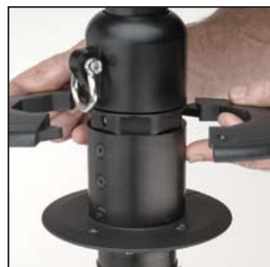
Con cuidado, retire primero el extremo inferior del alimentador. ¡No permita que se le caiga el alimentador por la borda!
