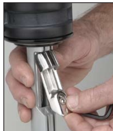
Con cuidado, retire primero el extremo inferior del alimentador. ¡No permita que se le caiga el alimentador por la borda!
