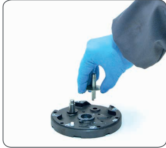
15. Remove washer n°9 and pin n°8
