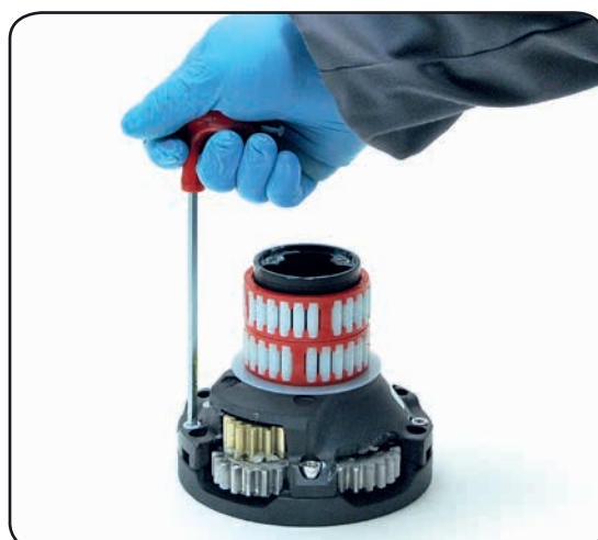
7. Unscrew the 6 hex screws n° 16 ( \approx 8\text{Nm}/71\text{ in-lb} )
