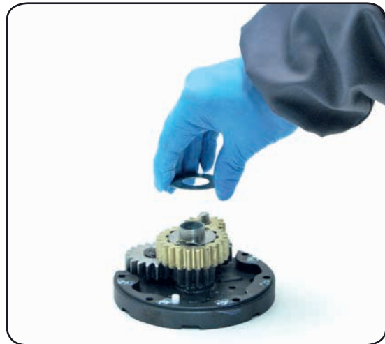
9. Remove the washer n°12
